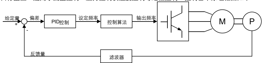
图 6.36 PID 控制基本原理框图
